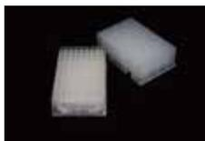
特点：适用于手动或自动的高通量生物样品制备，与传统的蛋白沉淀方法相比，96孔板的独特设计免去了离心和液体转移等繁琐步骤。
